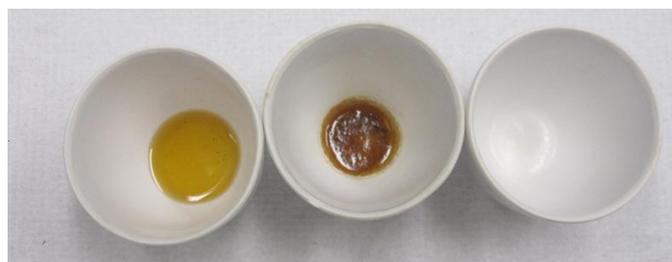
**Abbildung 4-4: Glycerin: Originalprobe, getrocknet, geglüht**
