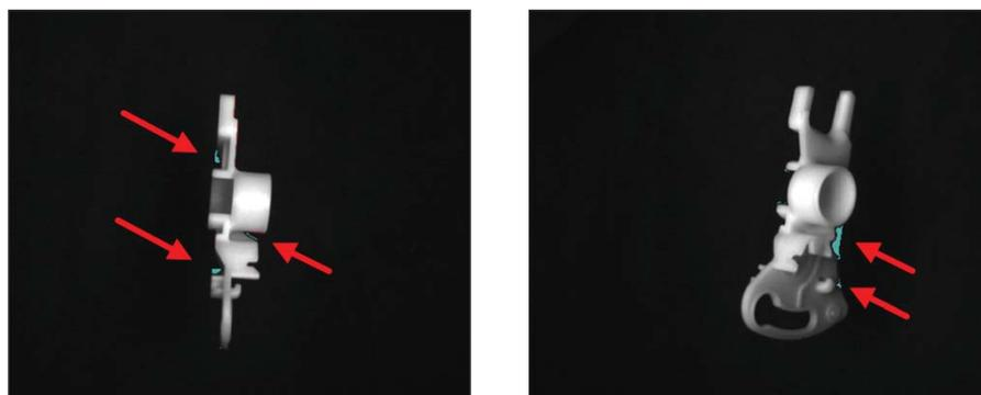
Abbildung 6: Linkes und rechtes Bild eines Datensatzes, in dem die Eigenabschattung des Prüflings irrtümlich fehlendes Material (blau) suggeriert.
