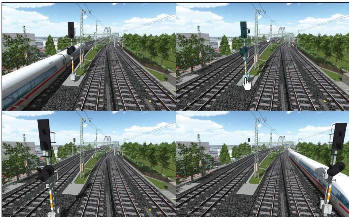
Abbildung 8: Wo ist der optimale Standort für ein Signal?
