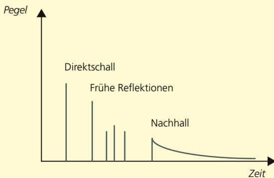
Abbildung 1: Schematische Darstellung der Unterdrückung akustischer Echos
