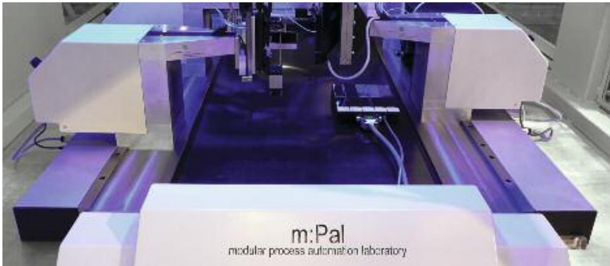
Die am Fraunhofer-Institut für Produktionstechnik und Automatisierung IPA entwickelte neue Plattform »Modular Process Automation Laboratory m:Pal« ermöglicht die schnellere und effizientere Planung komplexer Laborgeräte und hilft so, unnötige Mehrkosten einzusparen sowie rasch eine optimale Komponentenwahl zu treffen.
