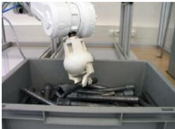
Bild 1 Greifen von ungeordneten Schmiedeteilen.
