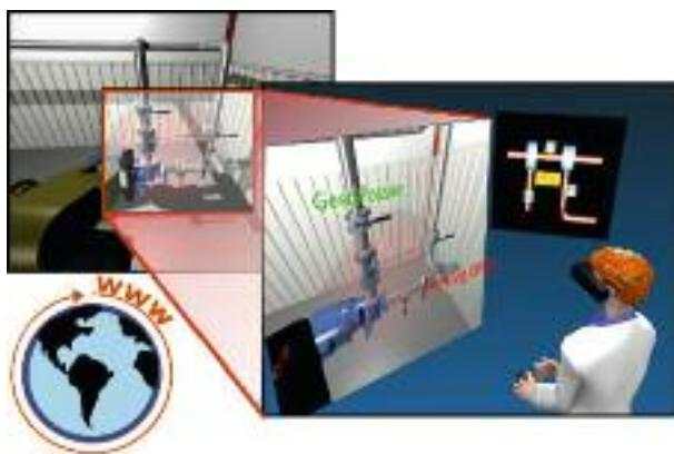
Bild 1 Benutzerunterstützung bei der Teleoperation eines Inspektionsroboters durch Augmented Reality.
