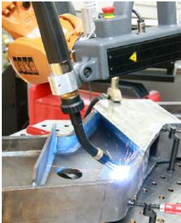
Bild 3 Mittels Vormachen programmierter Schweißprozess.
