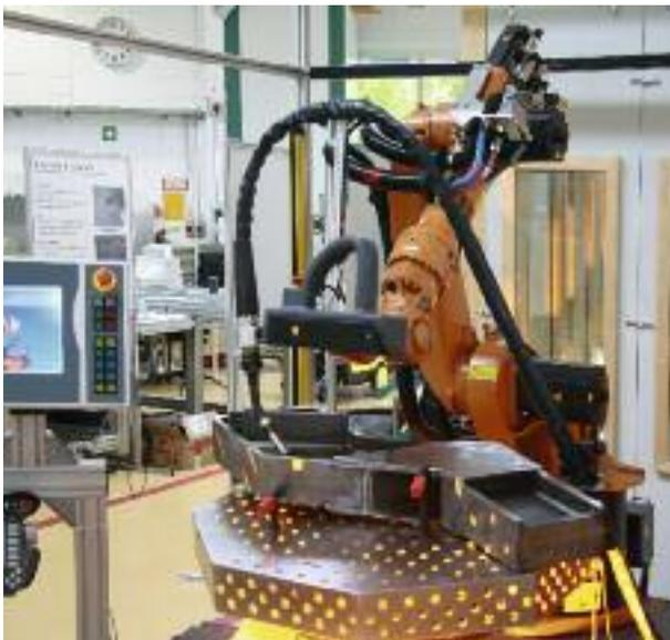
Bild 1 Programmierumgebung InTeach in einer Schweißapplikation.
