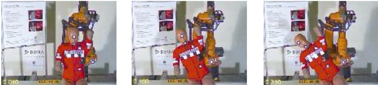
Bild 2 Crash Test zum Brustanprall des Roboters auf den Dummy, aufgenommen mit einer Hochgeschwindigkeitskamera.
