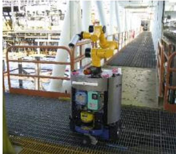
Bild 1 Inspektionsroboter Mimro im Einsatz auf einer Offshore-Plattform.
