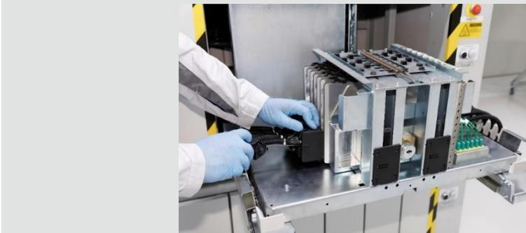
Abbildung 13: In der Zellkonditionierung wird die Zelle erstmals elektrisch kontaktiert, geladen, entladen und spannungsüberwacht gelagert. (Quelle: Volkswagen)
