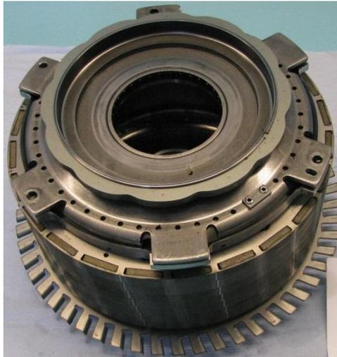
**Abbildung 13: ausgebauter Rotor aus Fahrzeug-Dauerlauf (Laufleistung ca. 130.000 km)**
