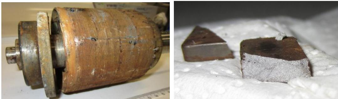
**Abbildung 12: links: stark verschmutzter Rückläuferrotor, rechts: Bruchfläche eines nur äußerlich verschmutzten Magneten dieses Rotors**
