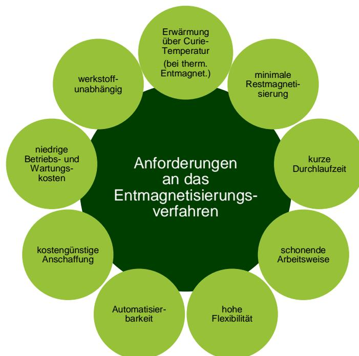
Abbildung 28: Anforderungen an geeignete Entmagnetisierungsverfahren
