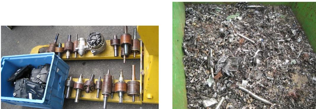
Abbildung 54: links: Beispiel für Shredder-Input-Zusammensetzung; rechts: Zerkleinertes Material
