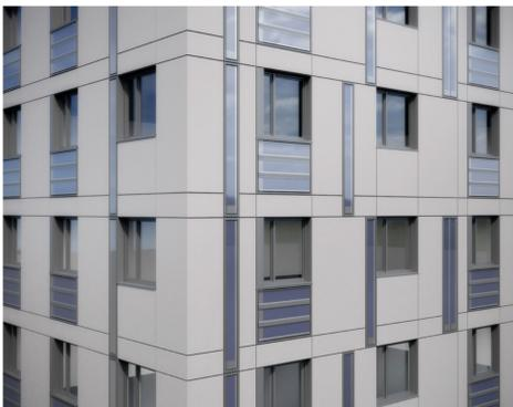
Abb. 1: Visualisierung einer Fassade mit Streifenkollektoren
