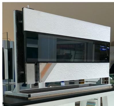
Abb. 2: Exponat mit individuellem Kollektorstreifen und Sammelkanal (links: Explosionszeichnung, rechts: Foto)
