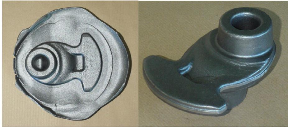
**Abbildung 9:** Schmiedeprototyp mit Grat (links) und nach dem Entgraten (rechts)
