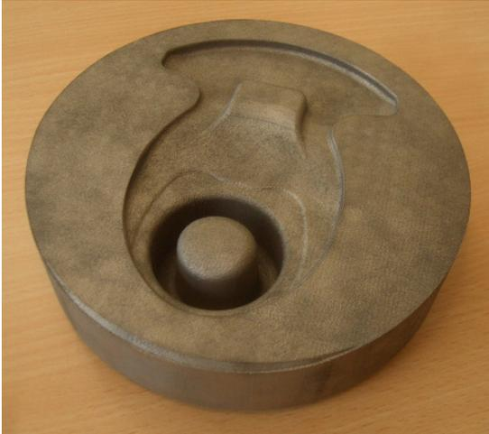
**Abbildung 6:** Laserstrahlgeschmolzener Gesenkeinsatz
