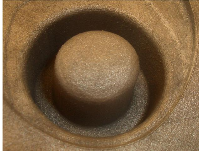
**Abbildung 7:** Dornbereich des laserstrahlgeschmolzenen Gesenkeinsatzes vor dem maschinellen Polieren
