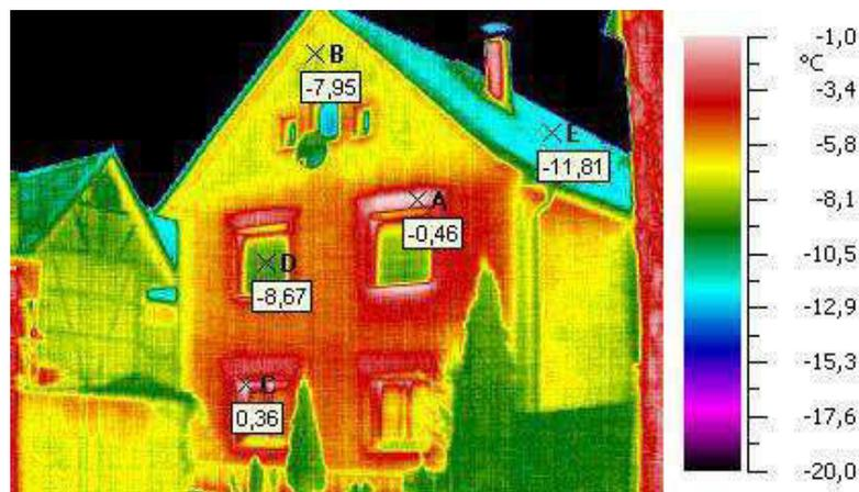
Wärmebildaufnahme einer ungedämmten Hauswand.<sup>1</sup>
