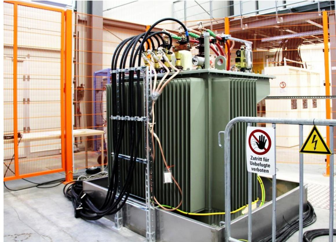
Prototyp eines steuerbaren MS-NS-Transformators der Firma J. Schneider Elektrotechnik GmbH. Tests im SysTec für das Projekt „Aktives, intelligentes Niederspannungsnetz“
