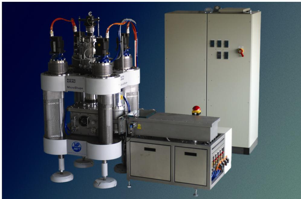
Abbildung 3: Anlagentechnik zur Heißformgebung von Metallen, Kunststoffen und Gläsern mit Handlingsystem
