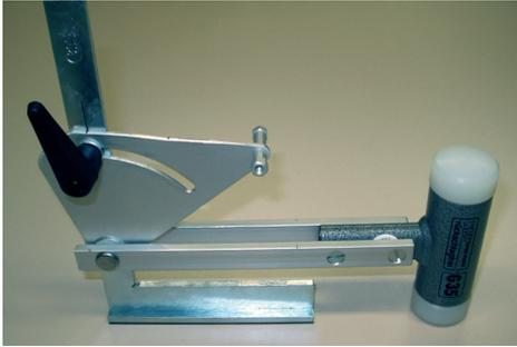
Bild 2: EMPA Pendelfallhammer zur Erzeugung von Benutzungsgereuschen nach SIA 181.
