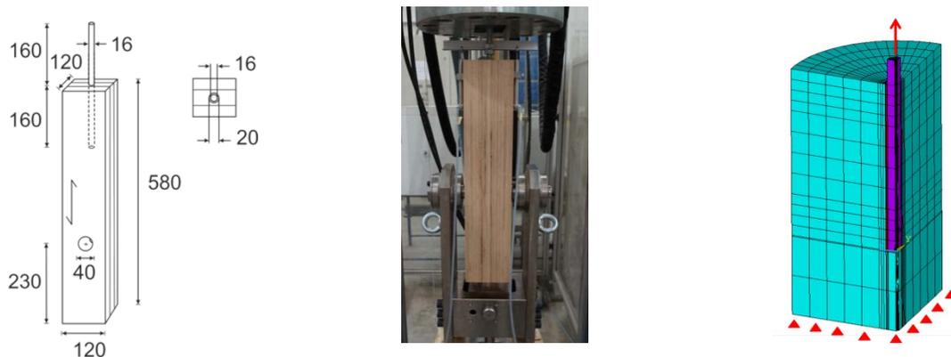
**Abbildung 1: (links) Geometrie der Großbauteilversuche; (mittig) eingespannter Probekörper in der für die Zugprüfung entwickelten Prüfvorrichtung; (rechts) FE-Modell**
