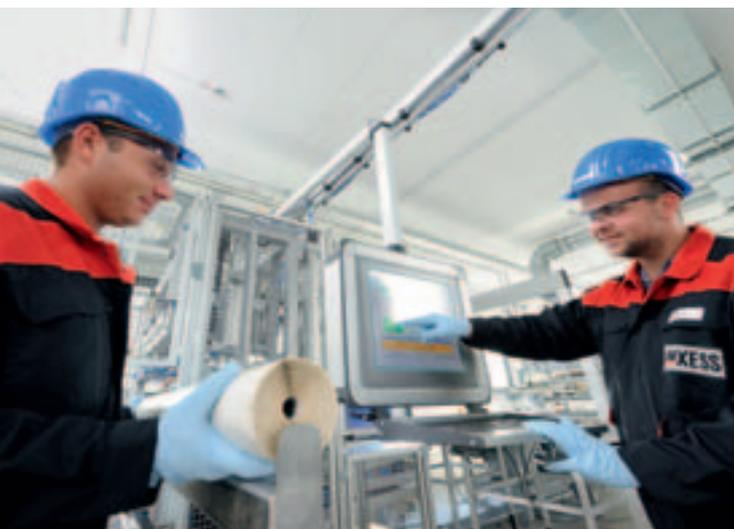
*Ein einzelnes Membranelement besteht aus einem Paket mit mehr als 20 Lagen. Dieses wird zu einem Wickelmodul angeordnet und fixiert. Die Forscher am Fraunhofer IFF haben vor dem Bau der Anlage den Wickelprozess simuliert, die teilautomatisierte Anlage entwickelt und aufgebaut, in Betrieb genommen und das Betriebspersonal geschult.*
