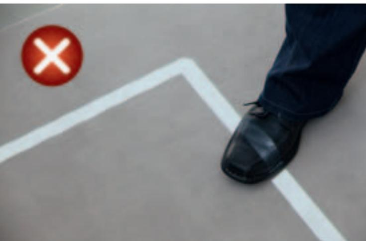
*Sichtbare Linien kennzeichnen den Schutzraum. Betritt eine Person diesen Bereich, unterbricht der Roboter seine Arbeit, optische und akustische Warnsignale werden aktiviert.*
