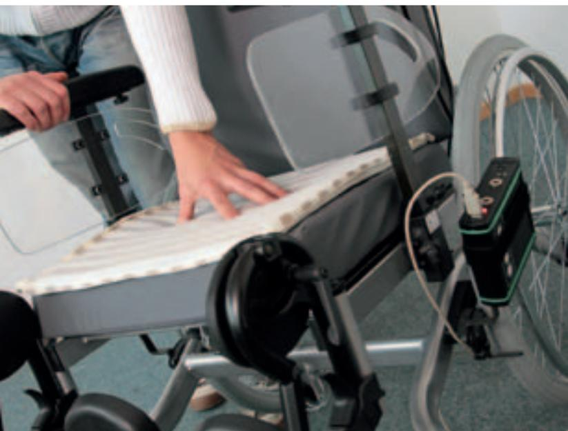
*Das »Wohlfühlpolster«, eine intelligente Sensormatte, erkennt genau, wo sich etwa bei Rollstuhlfahrern möglicherweise Wundgeschwüre entwickeln könnten. Ein neues Polsterkissen sorgt dann für punktgenauen Ausgleich.*
