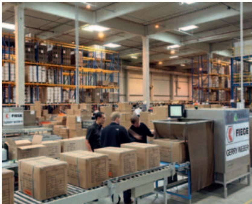
*RFID-Tunnelgate. Die mit am Fraunhofer IFF entwickelter RFID-Lesetechnik ausgestatteten RFID-Tunnel werden unter anderem vom Logistikdienstleister Fiege für die sichere Wareneingangskontrolle von Lieferungen des Textilherstellers Gerry Weber eingesetzt. Foto: Dirk Mahler*
