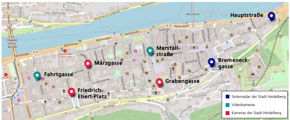
Abbildung 14: Kameras und Seitenradargeräte zur Erfassung des Verkehrsaufkommens in der Altstadt von Heidelberg
