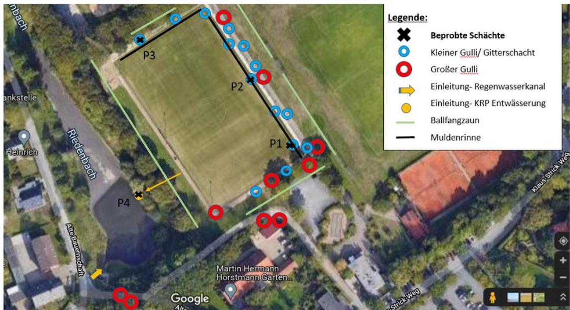
Abbildung 17: Ansichtskarte der kartierten Entwässerungsschächte auf dem Kunstrasenplatz OS-Nahne. Legende gibt Auskunft über verschiedene Entwässerungsschächte. Probennahme erfolgte an den mit „X“ gekennzeichneten Schächten P1-P4.
