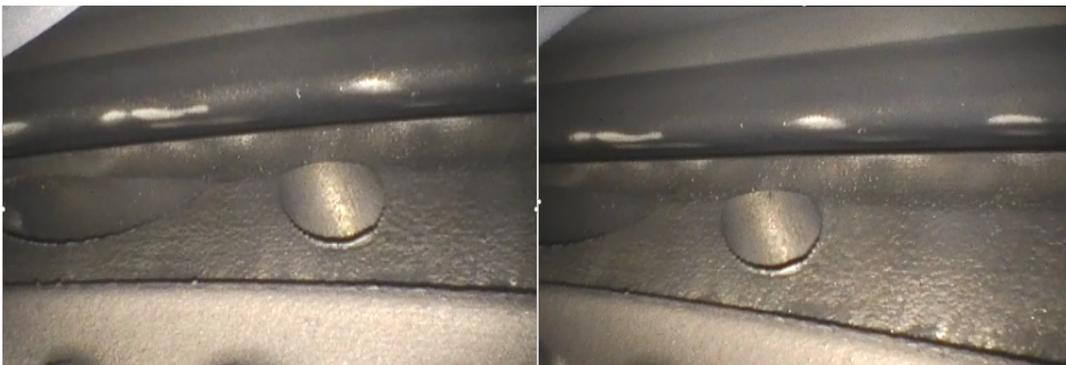
Abbildung 5.29: Muldenrand nach TMF-Versuch (links) und TMF/HCF-Versuch (rechts)
