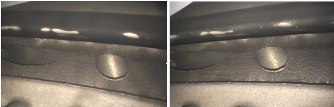
Abbildung 5.23: Aufzeichnung Videoskop nach 2885 TMF-Zyklen (links) und 7005 Zyklen (rechts)
