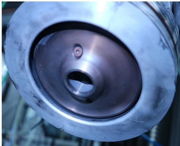
Abbildung 5.22: Foto des Kolbens nach 3306 Zyklen
