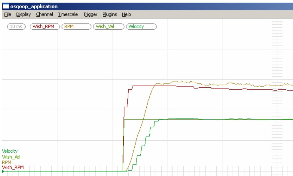
Abbildung 33: Ausregelvorgang der Lineargeschwindigkeitsregelung
