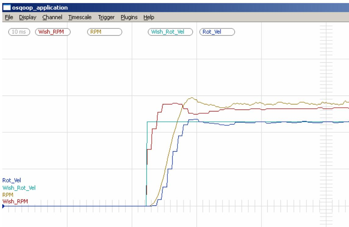
Abbildung 34: Ausregelvorgang der Rotationsgeschwindigkeitsregelung
