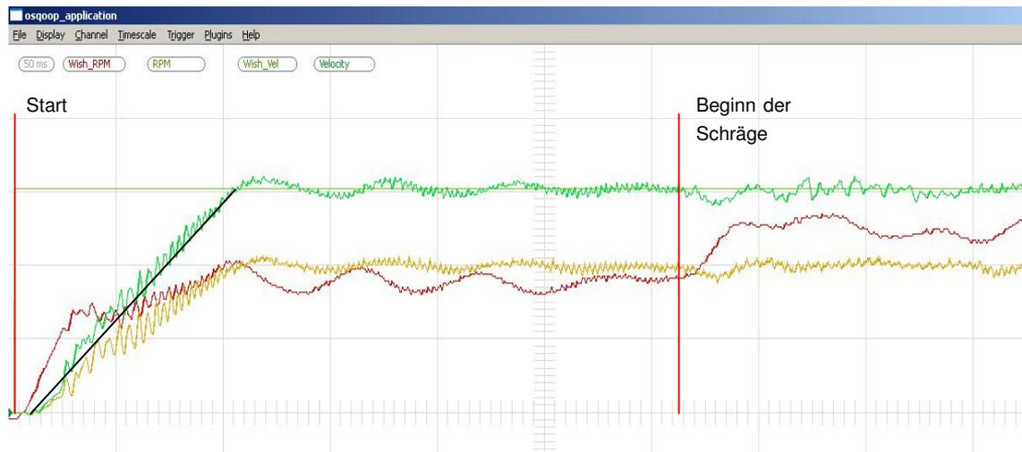
Abbildung 38: Reglerverhalten bei Lastwechsel
