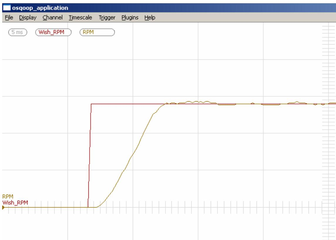
Abbildung 29: Soll- und Istwert der parametrisierten Drehzahlregelung
