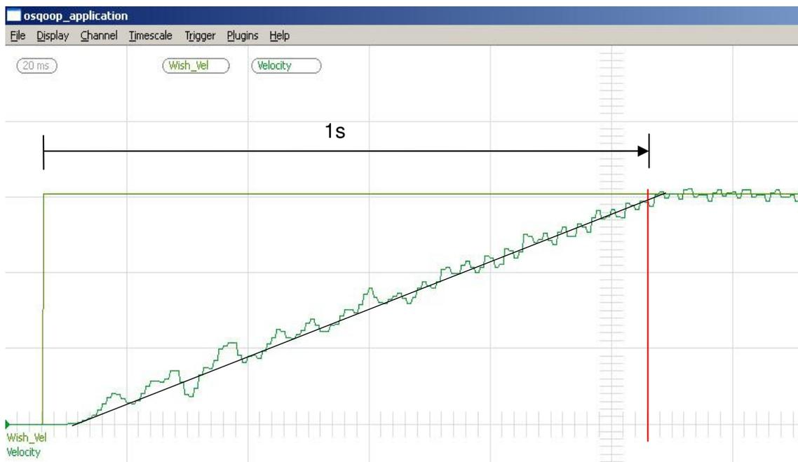
Abbildung 35: Positive Rampe der Geschwindigkeit
