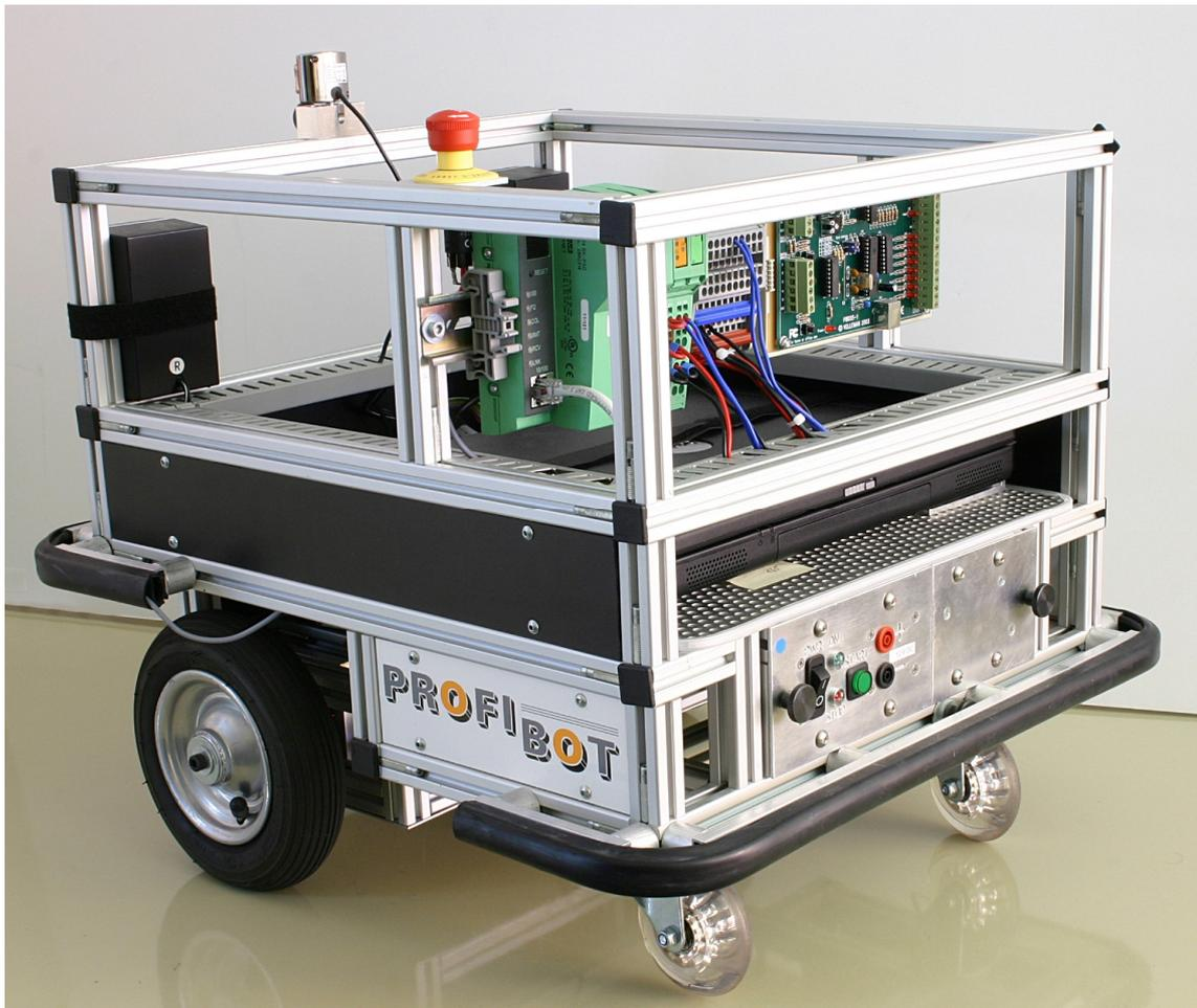
Abbildung 2: Baukastensystem ProfiBot (Foto: IAIS)
