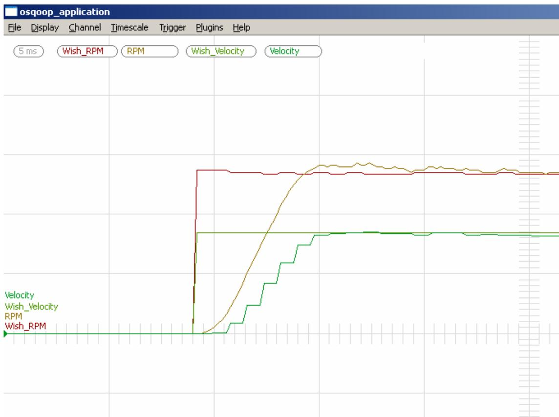
Abbildung 32: Sprungantwort der Lineargeschwindigkeit
