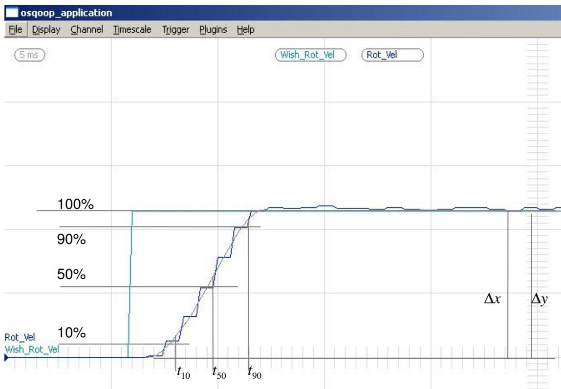
Abbildung 41: Analyse der Sprungantwort der Rotationsgeschwindigkeit
