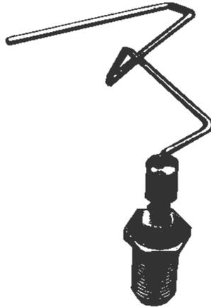
Abbildung 5: Antenne nach Durchlaufen des Evolutionsalgorithmus.<sup>126</sup>
