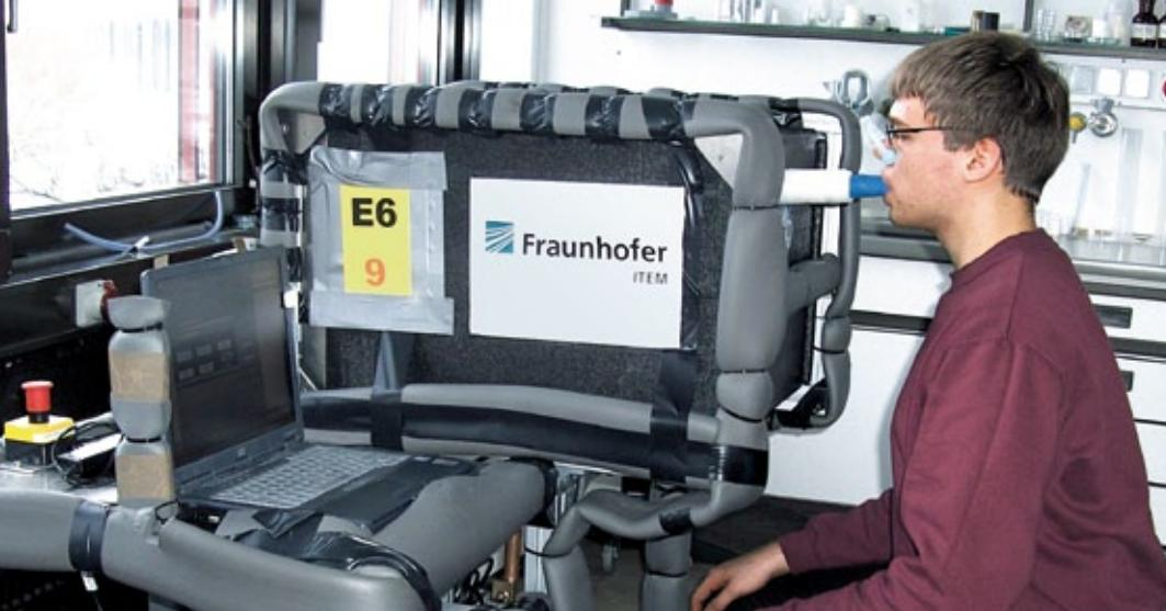
*Experimenteller Aufbau für die Charakterisierung endogen generierter exhalierter Aerosole*
