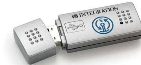
Abbildung 5.7: ZigBee USB Dongle von Integration [DONGLE]
