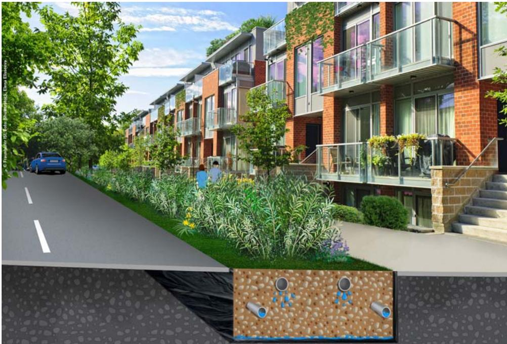
Abbildung 7-1: Energieallee: Mehrfachnutzung der urbanen Fläche zur Wasseraufbereitung, Wasserspeicherung und Bereitstellung von Ökosystemdienstleistungen (Quelle: Fraunhofer ISI)
