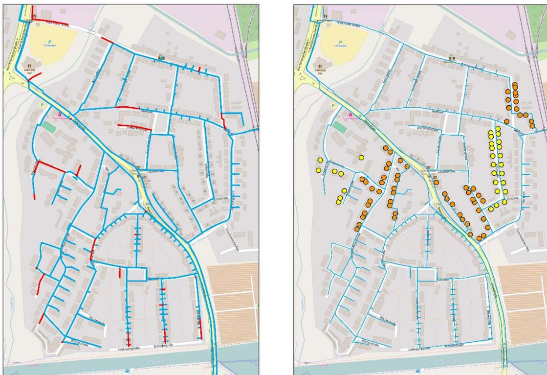
Abbildung 2: Trinkwassernetzabschnitte in Lünen mit Stagnationswahrscheinlichkeit (rote Abschnitte) vor (linke Karte) und nach zusätzlicher Vermaschung und Querschnittsanpassung (rechte Karte)
