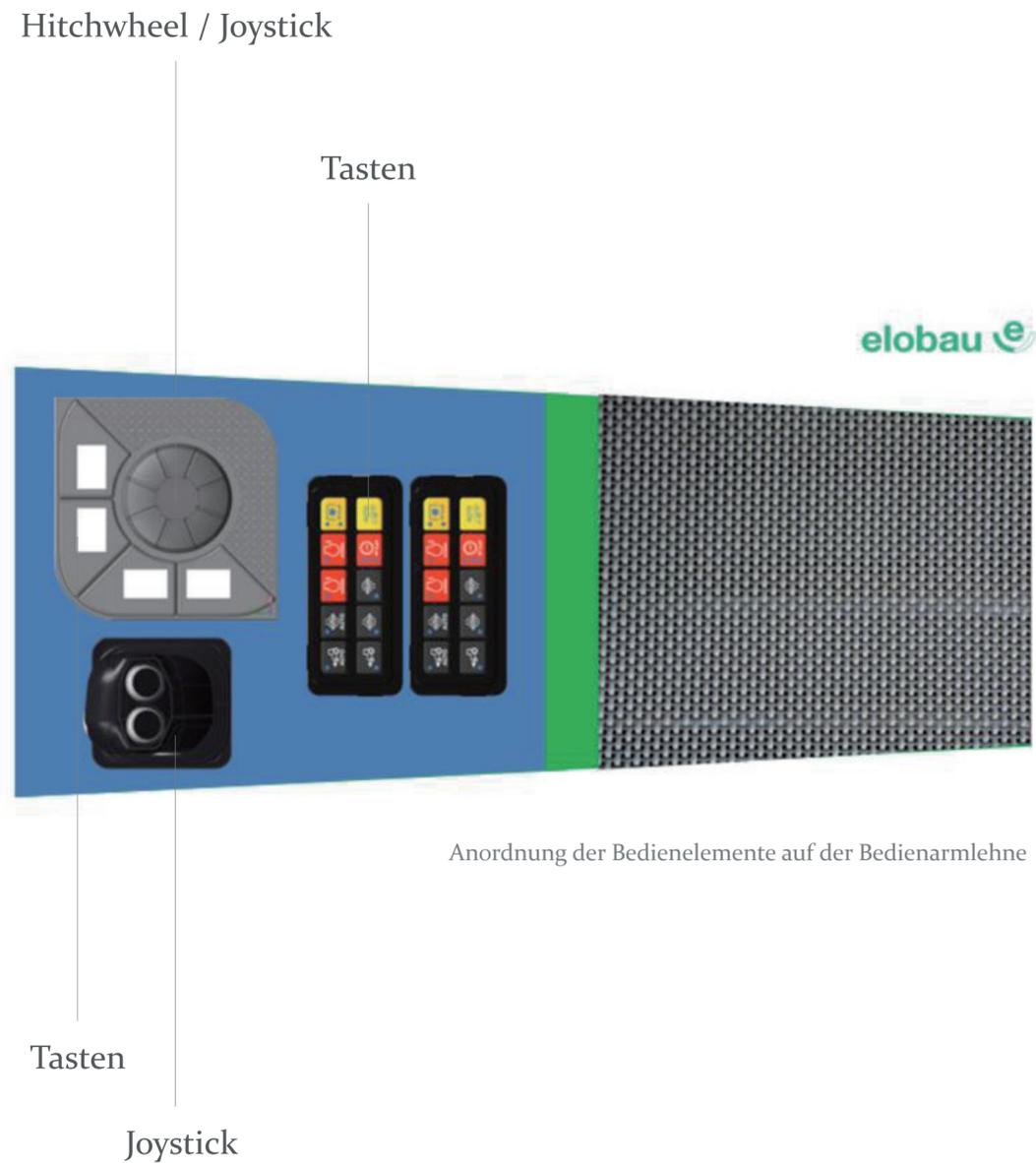
Elobau entschied sich für die Installation der folgenden Komponenten an der neuen Bedienarmlehne: einen multifunktionalen Bedienbereich, einen Joystick und zwei Tastenreihen. Dazu gehören grundsätzlich die grundlegenden betrieblichen Anforderungen eines Nutzfahrzeugs. Die Funktionen aller Teile können programmiert und angepasst werden.
