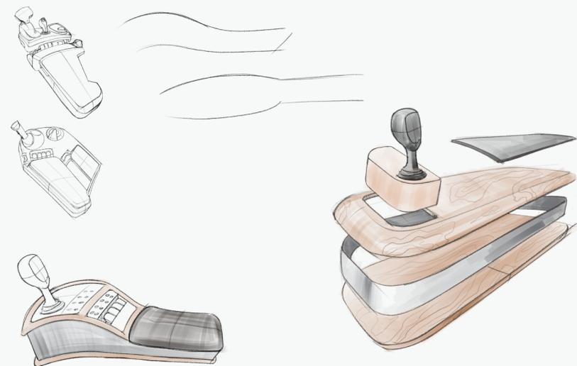
**Das erste Konzept:** Metall wird als Stützrahmen verwendet, Teile werden daran befestigt und eine Kunststoffschale ist außen abgedeckt. Holz kann am Boden und an den Armlehnen verwendet werden, wenn keine Präzision erforderlich ist.
