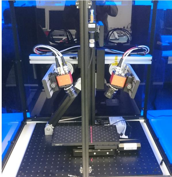
**Abbildung 2.13:** Laserlichtschnitt Demonstrator
