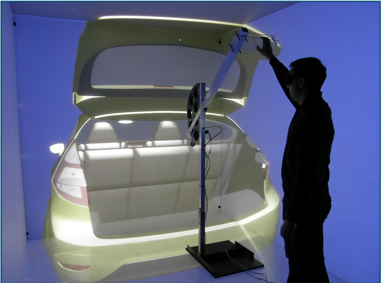
Abbildung 4 Smart Hybrid Prototyping zur visuellen und haptischen Nachempfindung des Schließverhaltens einer Heckklappe
