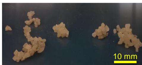
Abbildung 2.1.4.17: Materialblockade im Hopper durch aneinander klebende Granulate
