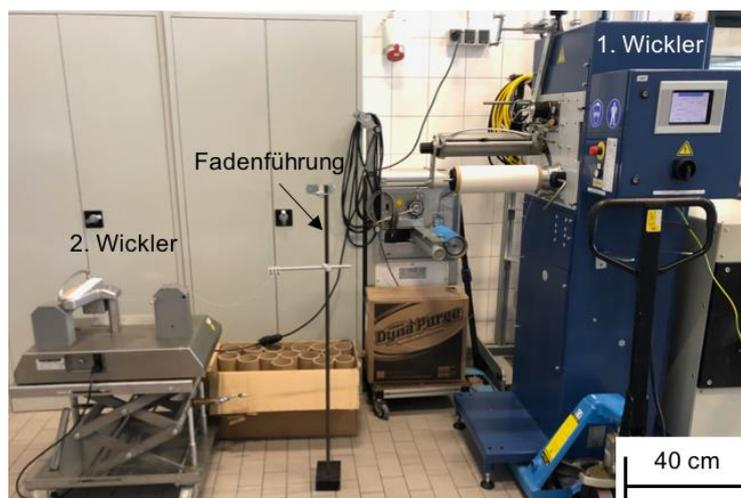
Abbildung 2.1.4.26: Aufbau des Umspulversuches
