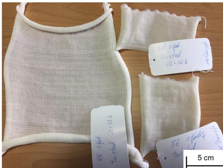
Abbildung 2.1.6.4: Drei Proben, links ungedämpft, rechts gedämpft mit 140°C
