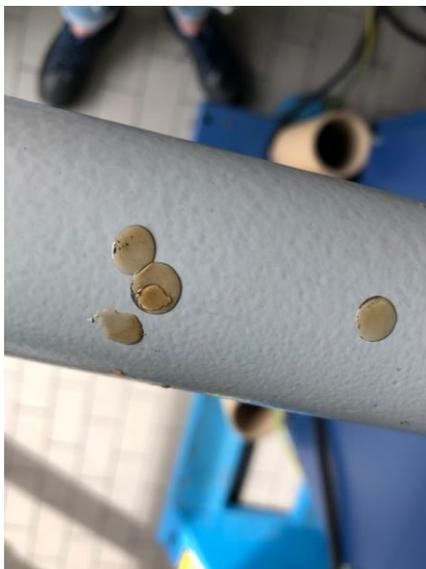
Abbildung 2.1.4.23: Tropfen aus der Düse bei Schmelzspinnversuchen mit Compound SXC4292
