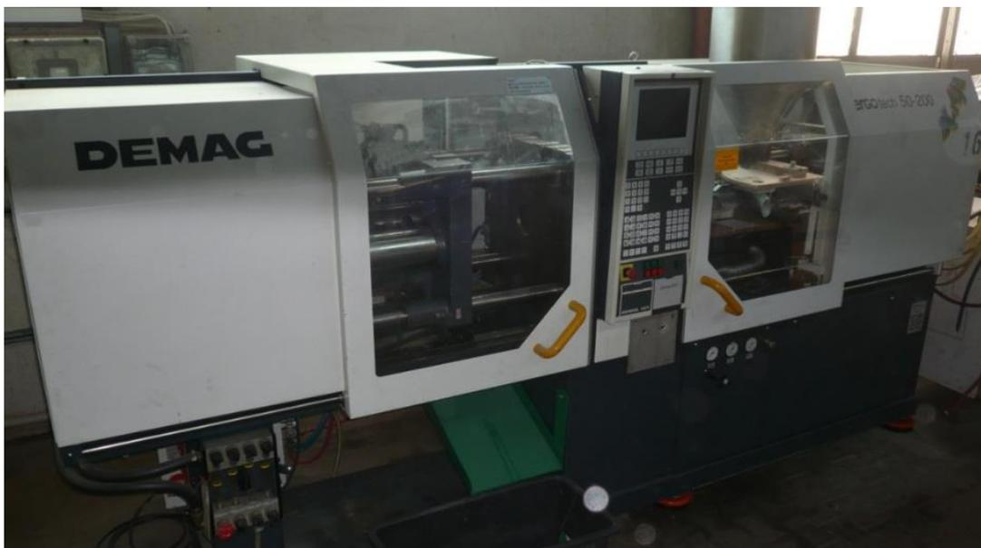
Abbildung 2.1.3.1: Spritzgießmaschine bei Tecnaro zur Herstellung von Prüfkörpern
