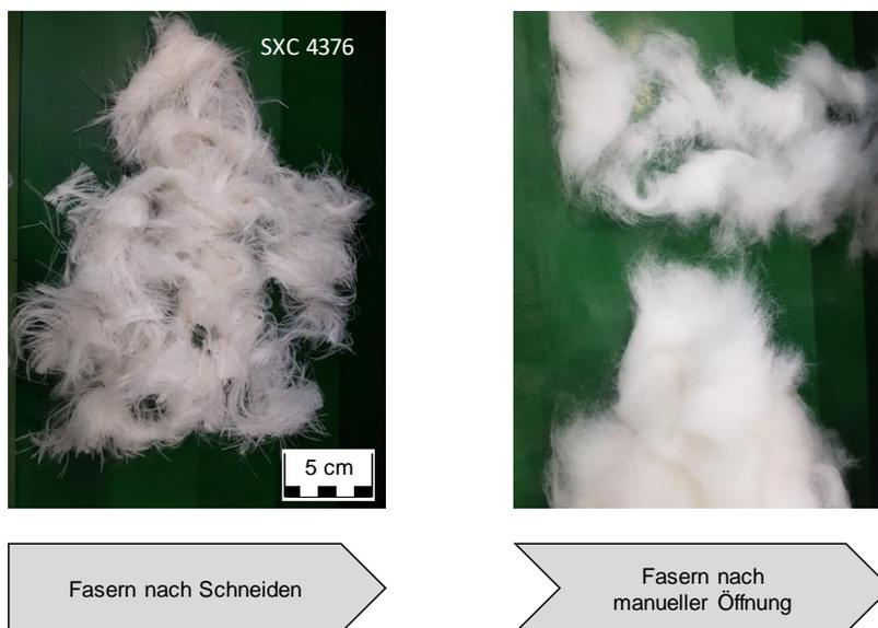
Abbildung 2.1.5.10: Fasern aus Compound 4376 nach dem Schneiden und nach manueller Voröffnung
