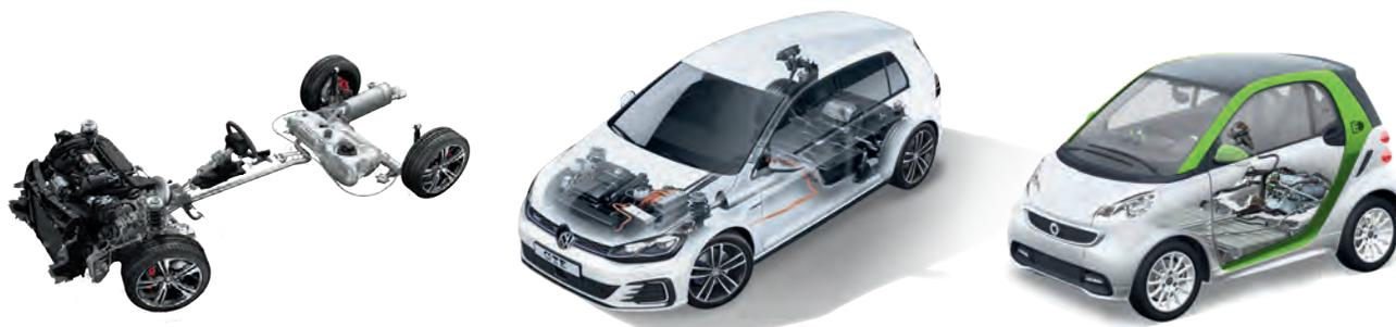
Abb. 6: Im Projekt ELAB 2.0 behandelte Antriebsstränge ICEV, PHEV, BEV (von links; Quellen: Peugeot, Volkswagen, Daimler)
