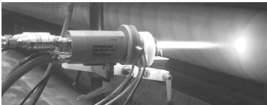
**Bild 14:** Hochgeschwindigkeitsflammspritzen (HVOF)
