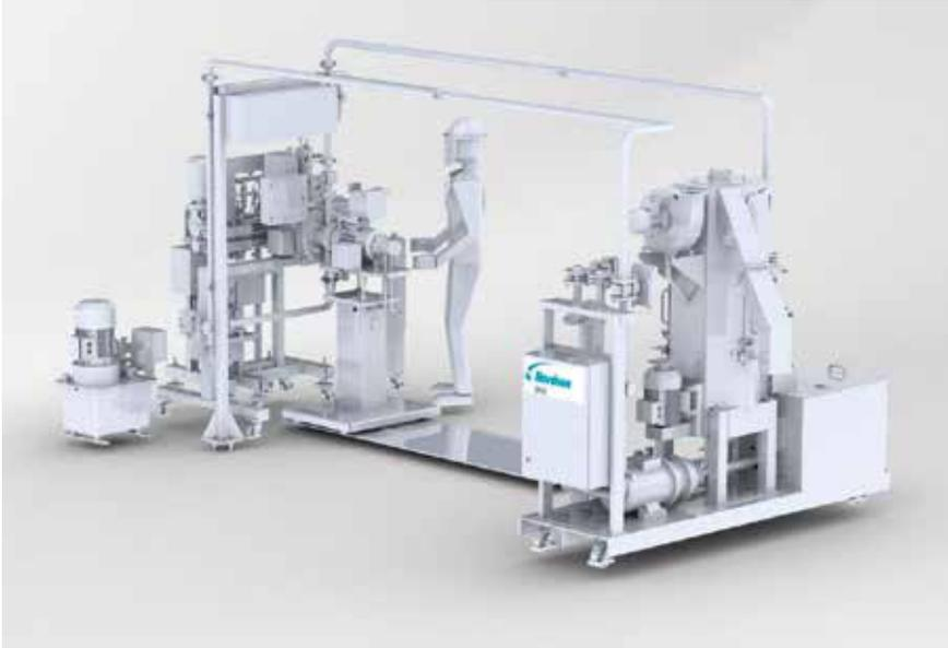
**Bild 4.** Modell einer Anlage für Unterwassergranulierung
