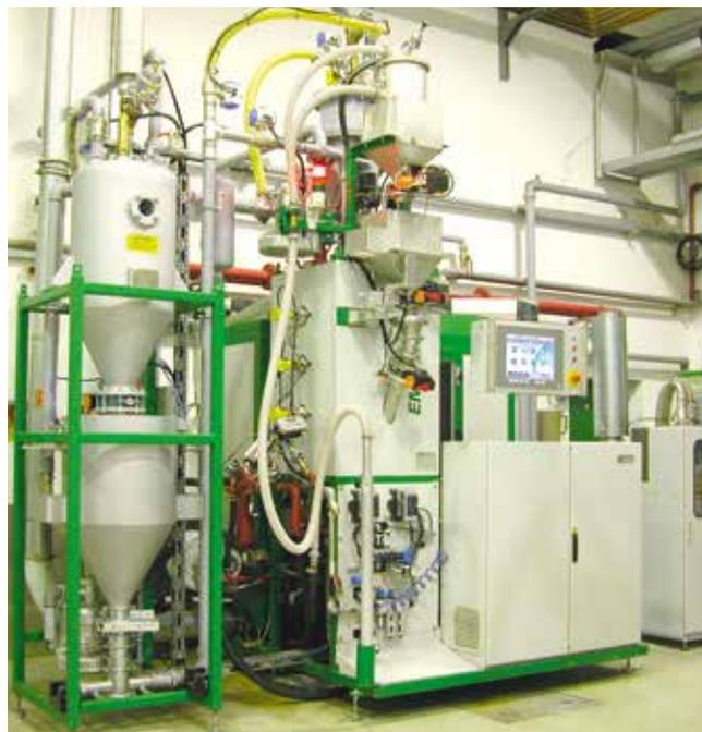
**Bild 6.** Modell des Vorschäumers ED2-HP mit gravimetrischer Einwaage
