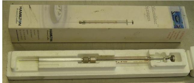
Abbildung 6-3: Verwendete  $\mu\text{l}$ -Spritze
