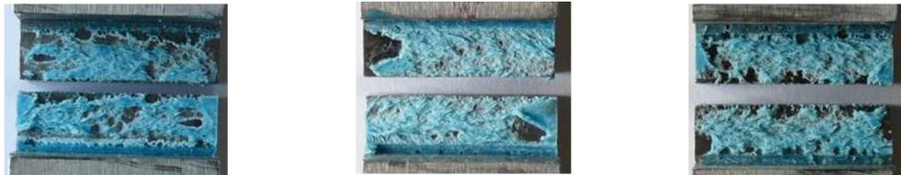
Abbildung 6-23: Beispielhafte Bruchbilder dicke Scherzugprobe – Oberflächenvorbehandlung Plasma-Aktivierung
