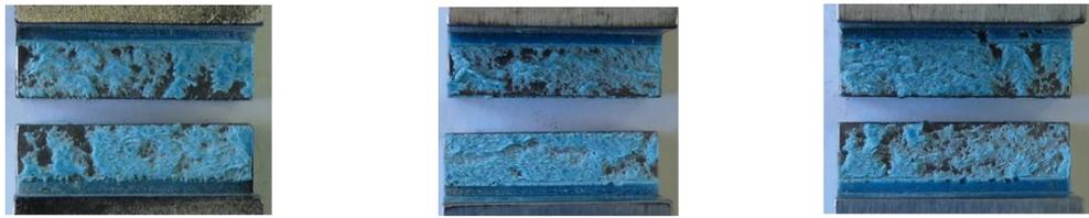
Abbildung 6-22: Beispielhafte Bruchbilder dicke Scherzugprobe – Oberflächenvorbehandlung Reinigung mit n-Heptan mit anschließender gezielter Beölung mit 3 g/m² Fuchs Anticorit
