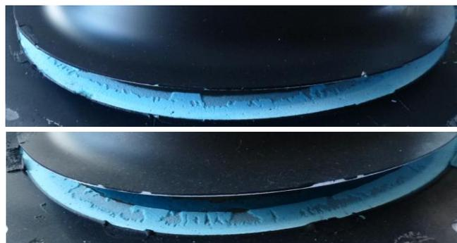
Abbildung 6-38: Beispielhafte Bruchflächen an bauteilähnlicher Probe
