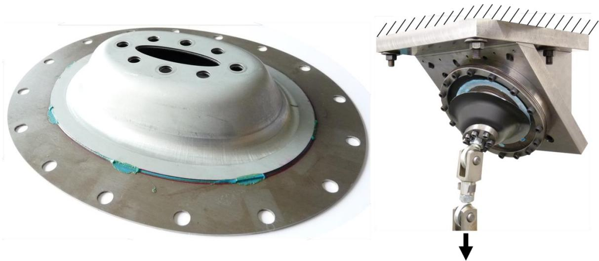
Abbildung 5-7: Realisierte bauteilähnliche Probe (links) und Einspannung (rechts)
