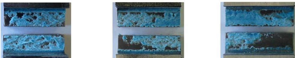
Abbildung 6-21: Beispielhafte Bruchbilder dicke Scherzugprobe – Oberflächenvorbehandlung Reinigung mit n-Heptan
