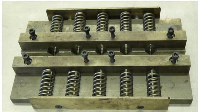
Abbildung 6-4: Verwendete Klebvorrichtung für dicke Scherzugproben
