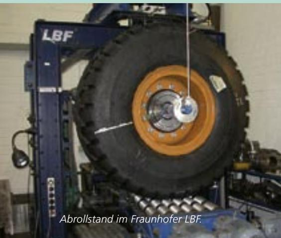
Abrollstand im Fraunhofer LBF.
