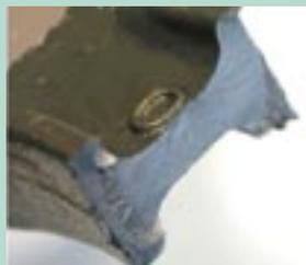
Abb. 2: Berechneter höchstbeanspruchter Bereich im Schaft und Bruchlage im Versuch.
