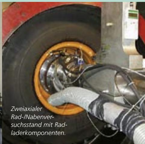
Zweiachsaler Rad-/Nabenversuchsstand mit Radladerkomponenten.
