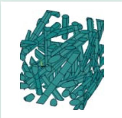
Beispielinheitszelle mit geraden Fasern, Faservolumen (links) und Matrixvolumen (rechts).
