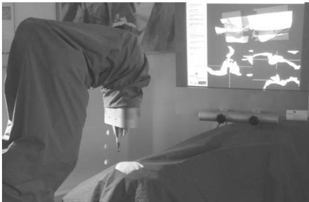
Abbildung 8.1: Realisierter Versuchsaufbau zur Durchführung von roboterassistierten Fräsungen an der lateralen Schädelbasis *ROBIN* (*RO*Boter mit *I*ntegrierter *N*avigation)
