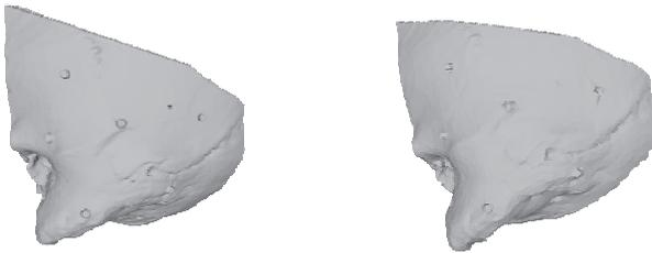
Abbildung 8.4: Erstellung der Oberfläche aus den CT-Scans des Präparats. Links nach der Triangulation (ca. 250.000 Knoten), rechts nach Glättung und Reduktion (ca. 8000 Knoten)
