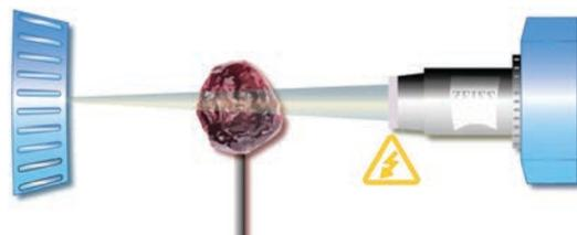
**Abbildung 1:** Schematischer Aufbau eines Röntgenmikroskops. Es gibt zwei Vergrößerungen, eine geometrische (Dia-Projektor-Prinzip) und eine optische (Objektiv). Am Szintillator vor dem Objektiv wird das Röntgenbild in den sichtbaren Spektralbereich „übersetzt“.
