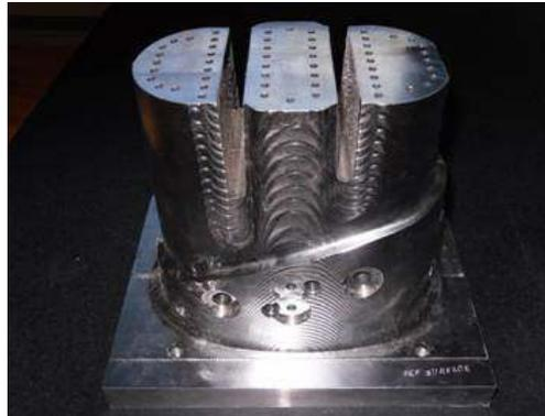
gefräster Grundkörper mit Kühlbohrungen (vorgeschruppt)
