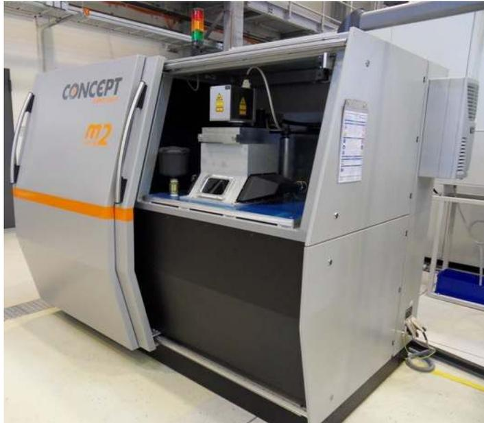
Laserstrahlschmelzanlage M2 Cusing
