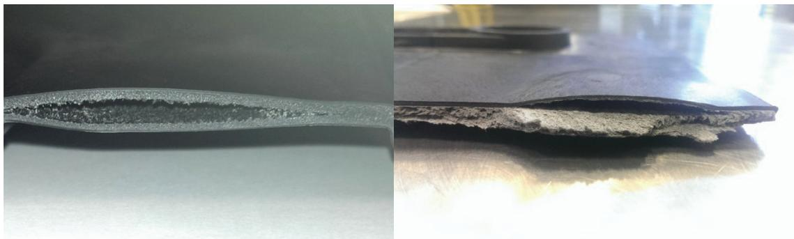
Aufreißen der Zellwände in der Querschnittsmitte (links),
