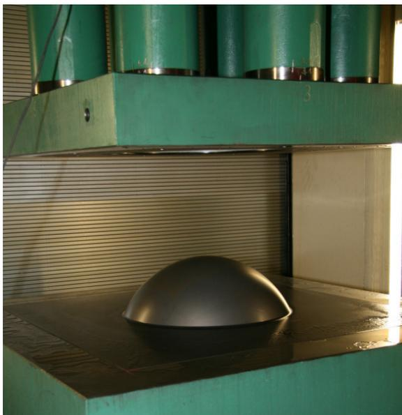
Bild 2: MBT-Werkzeug im eingebauten Zustand und umgeformte MBT-Probe
