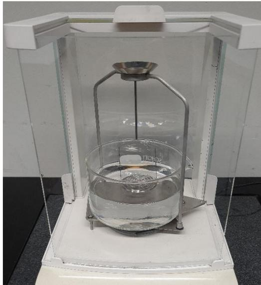
Abbildung 4.1: Messaufbau zur Dichtebestimmung (eigene Aufnahme).
