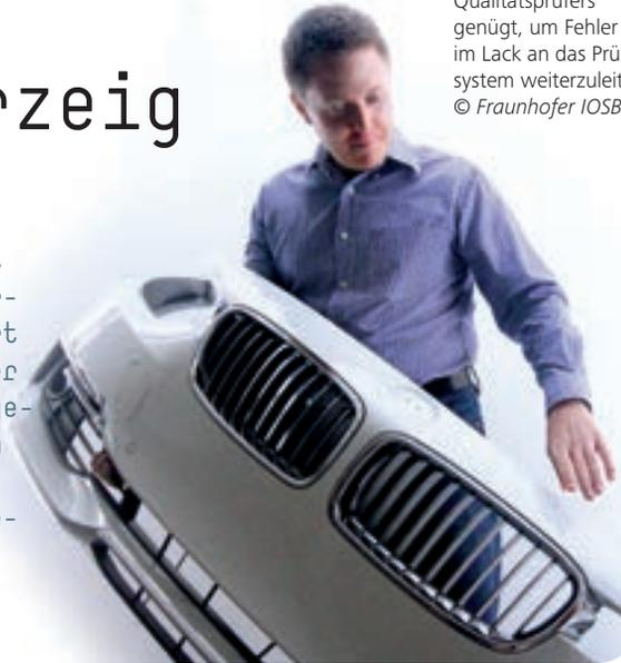
Ein Fingerzeig des Qualitätsprüfers genügt, um Fehler im Lack an das Prüfsystem weiterzuleiten. © Fraunhofer IOSB
