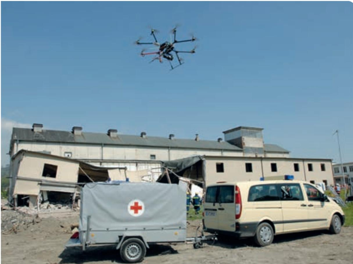
Vernetzte Aufklärung mit fliegenden Robotern, die mit IR-Kameras ausgestattet sind und aufzeigen können, wie umfangreich die Zerstörung ist und ob es überlebende Opfer gibt. © Bernd Müller/Fraunhofer
