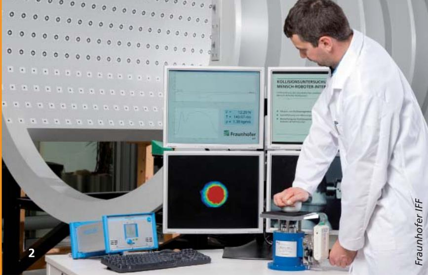
suche sowohl die Pendelmasse als auch die Kollisionsgeschwindigkeit über die Pendelauslenkung variiert werden. Insgesamt wurden bis zu sechs Körperbereiche in drei verschiedenen Körperhaltungen mit Stößen beaufschlagt, für die eine Parametrierung der Umrechnungsfunktion erfolgen sollte.
