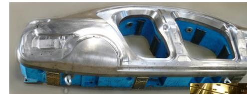
Presse mit Werkzeug zur Herstellung von PKW-B-Säulen
