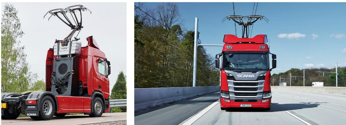
Abbildung 1: Hybrid-Oberleitungs-Lkw (Quelle: „Scania CV AB“)
