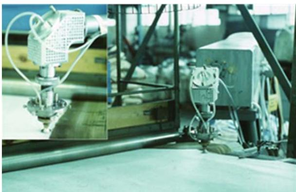
Abb. 4 Laserrandbeschnitt von Polyamid-Elementarfadenvliesstoff vor der Beschichtung in Olbersdorf (1976)
