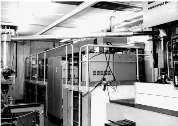
Abb. 6: Blick ins 1. Applikationslabor des ZFW Dresden, Mitte: Laser Katun, rechts: modifiziertes Koordinatenbohrwerk (Mikromat), links: Laser SM 400 einschl. Strahlübertragung
