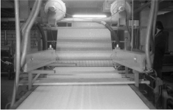
Abb. 5 Spann-, Trocken- u. Fixiermaschine mit integrierten CO<sub>2</sub>-Lasern und Randstreifenabsaugungen zum Randbeschnitt von Regenschirmbespannstoff in Greiz (1979)
