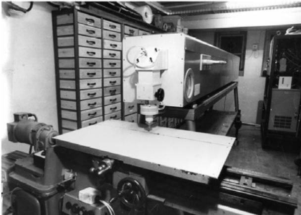
Abb. 3 Transportabler 200 W-CO<sub>2</sub>-Laser mit Bearbeitungskopf im Labor an der TU Dresden (1974)
