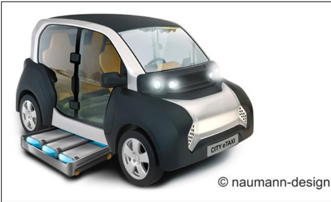
▲ Bild 1: Adaptive City Mobility - Fahrzeug mit Batteriewechselkonzept
