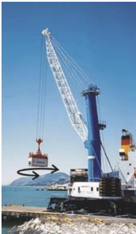
Hafemobilkran Liebherr LHM 400, max. Tragkraft 104 t; Eigengewicht 400 t; installierte hydraulische Antriebsleistung 600 kW.
