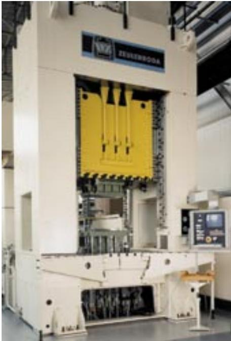
Abb. 1: Tiefziehpresse mit Mehrpunktziehtechnik am Fraunhofer IWU, Chemnitz.
