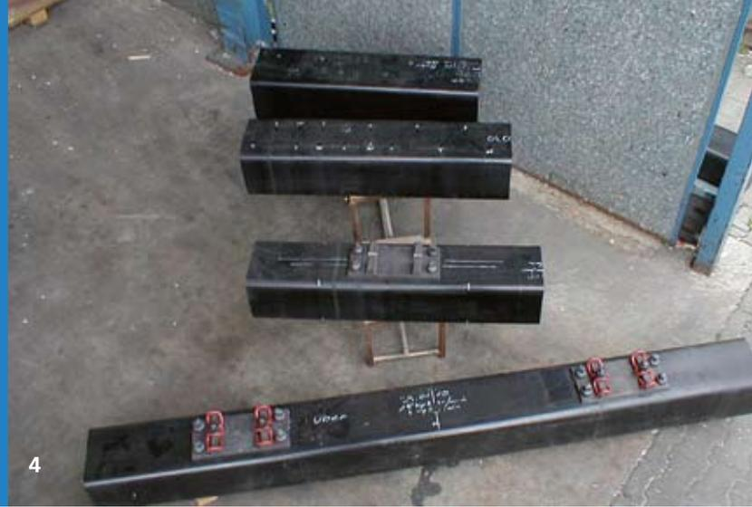
Zur Prüfung der Homogenität der auf dieser Anlage produzierten Profile wurden diese in einer Klimakammer auf 50 °C erhitzt und während des Abkühlvorgangs mit Hilfe einer Wärmebildkamera untersucht. Auf diese Weise konnten eventuell vorhandene größere Hohlräume entdeckt, aber auch die Homogenität der Schwellen gezeigt werden.
