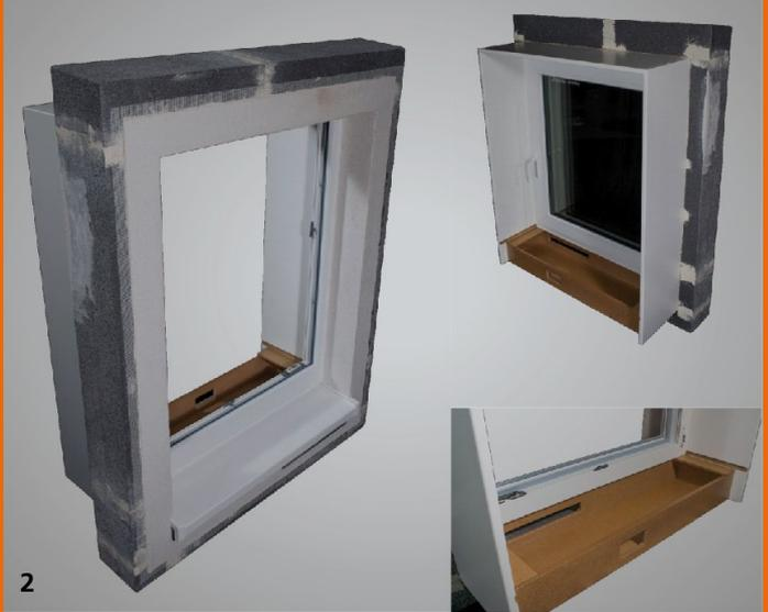
In dieser Box können ebenfalls Komponenten wie z. B. Brandschutzeinrichtungen, dezentrale Heizungs-pumpen, Luftfilter sowie Schalldämpfer platziert werden, die als »Aufputz-Installation« vom Nutzer nicht akzeptiert würden. Auf Grund der demontierbaren Fensterbank ist die Wartung, die Nachrüstung oder der Austausch von Komponenten leicht möglich.
