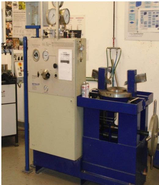
**Prüfstand** zur Druckprüfung an Sicherheitsventilen sowie Regel- und Absperrarmaturen
