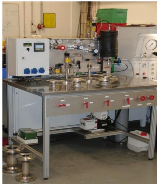
**Kalibrierstand** zur Kalibrierung und Befüllung der Kapillare von Druckmessumformern
