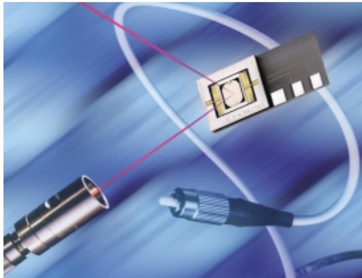
um zwei Achsen gekippt werden können. Die Spiegelplatten sind an Torsionsfedern aufgehängt und können innerhalb eines großen Winkelbereichs definiert bewegt werden. Auch das Material der Aufhängung ist wichtig, während
