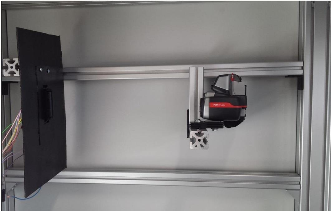
**Abbildung 21: Versuchsaufbau mit schwarz lackierter Batterie sowie Wärmebildkamera**
