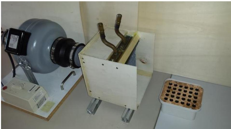
**Anhang A3: Versuchsaufbau zur Validierung der Berechnungen mit einem einstellbaren Gebläse, einer Strömungsführung mit eingebautem Kühler zur Lufttemperierung und einem noch nicht fertig konstruierten rechteckigen Batterieblock**
