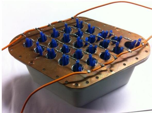
**Abbildung 22: Rhombischer Batterieblock Prototyp**
