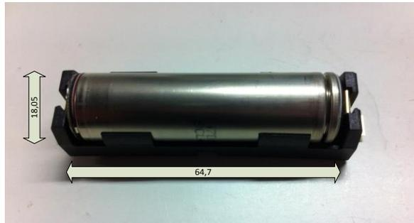
Abbildung 20: Batterie zelle mit Halterung
