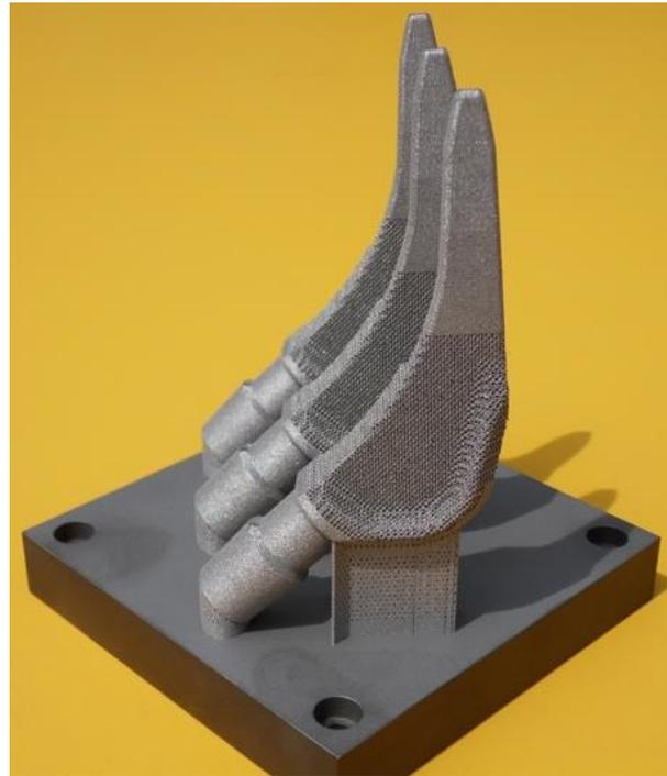
Laserstrahlgeschmolzene Implantate auf der Bauplattform
