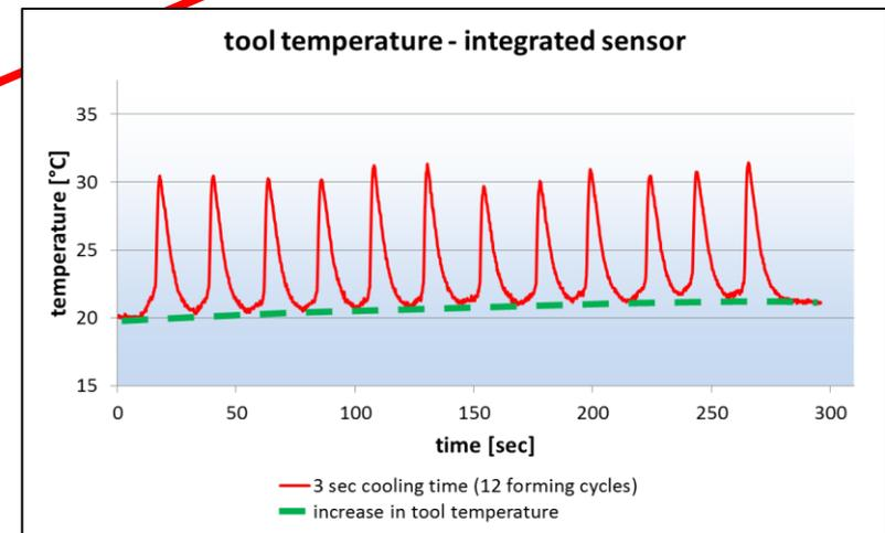
Messung der Werkzeugtemperatur über 12 Umformungen
