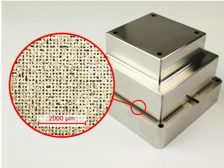
generativ gefertigter Werkzeugeinsatz (Demonstratorwerkzeug) mit poröser Entlüftungsstruktur und Flächenkühlung
